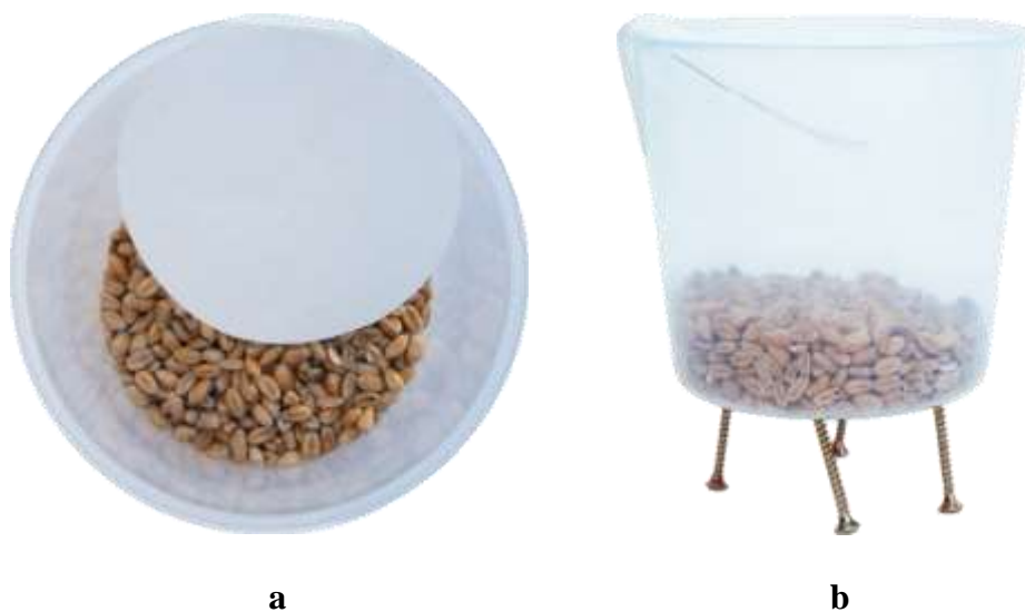
Fot. 20. Usytuowanie krążka bibuły filtracyjnej w małym naczyniu doświadczalnym: a) widok z góry; b) widok z boku. (Fot. A. Izdebska)
