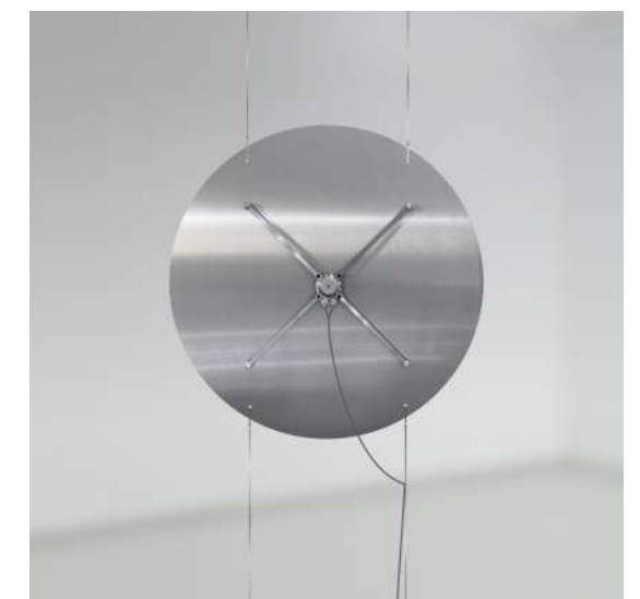
Largo na trzy punkty detal, wzbudnik audio umieszczony na płycie, blacha, naciągi stalowe, przewody
