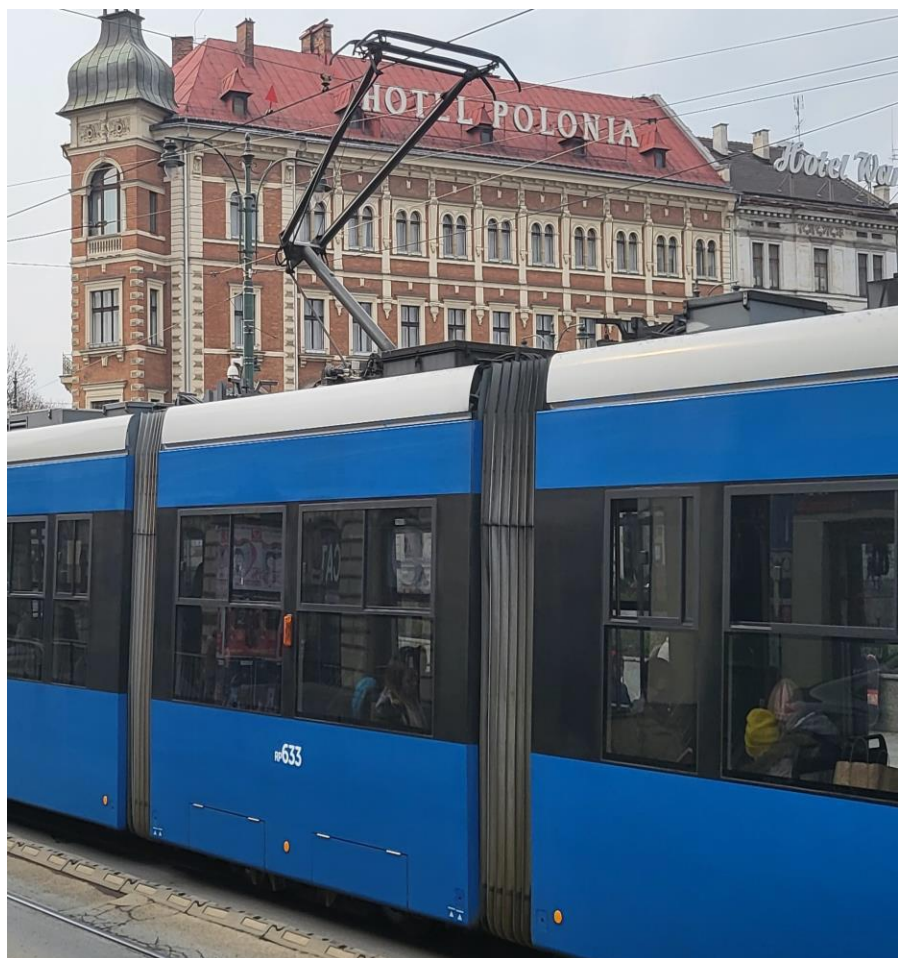
Ryc. 60. Położenie odbieraka prądu podczas „normalnej” jazdy oraz przy wjeżdżaniu pod wiadukt kolejowy na ul. Lubicz w Krakowie Źródło: Zdjęcie własne.
