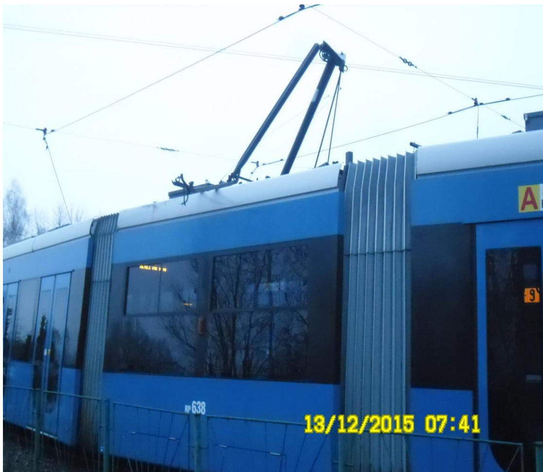
Ryc. 24. Połamany odbierak prądu w tramwaju typu NGT6
