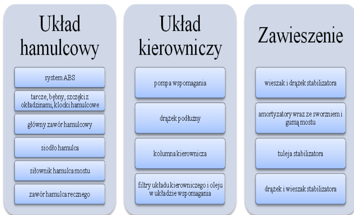
Ryc. 9. Klasyfikacja głównych awarii w układzie hamulcowym, kierowniczym i zawieszeniu mającym wpływ na bezpieczeństwo prowadzonego pojazdu
