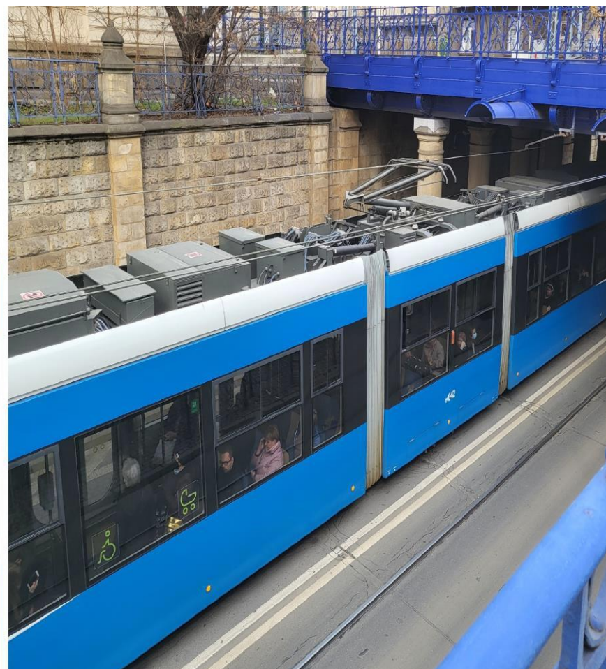
Ryc. 60. Położenie odbieraka prądu podczas „normalnej” jazdy oraz przy wjeżdżaniu pod wiadukt kolejowy na ul. Lubicz w Krakowie Źródło: Zdjęcie własne.
