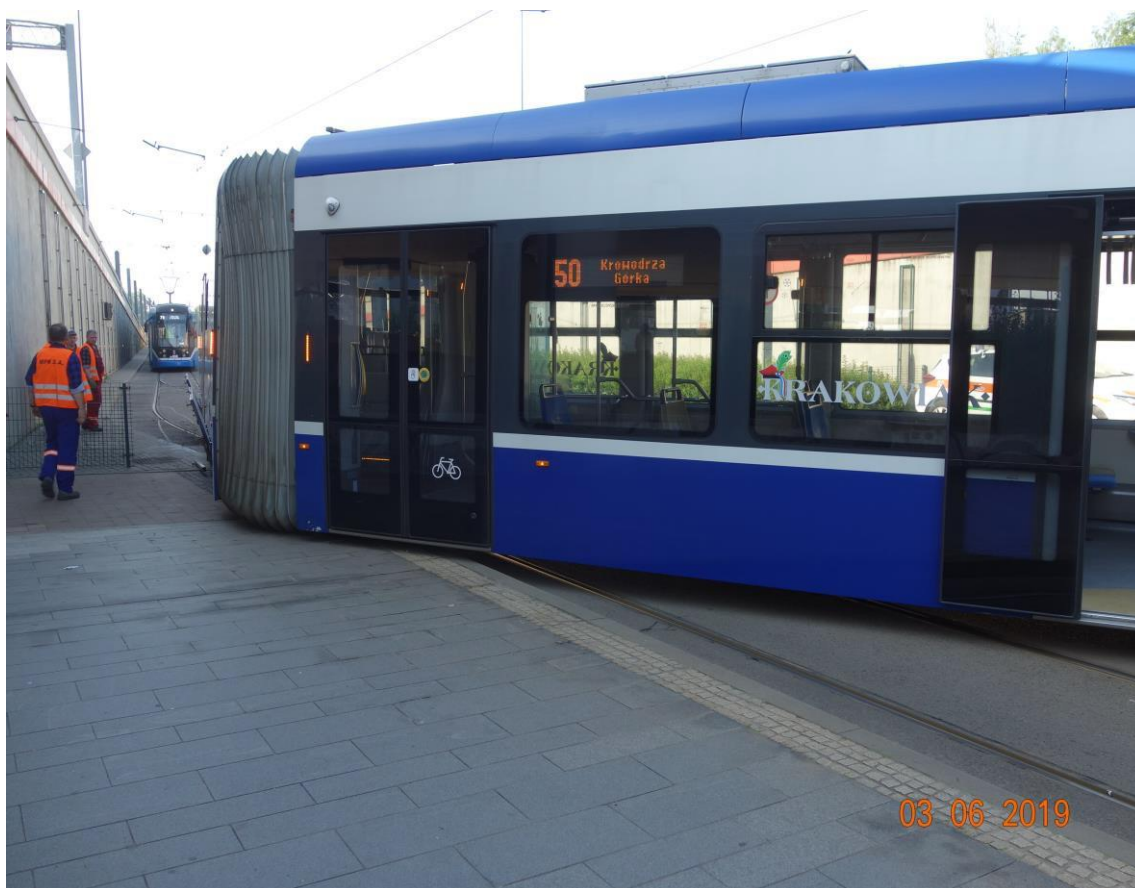
Ryc. 25. Wykolejenie tramwaju typu 2014N na zwrotnicy rozjazdowej
