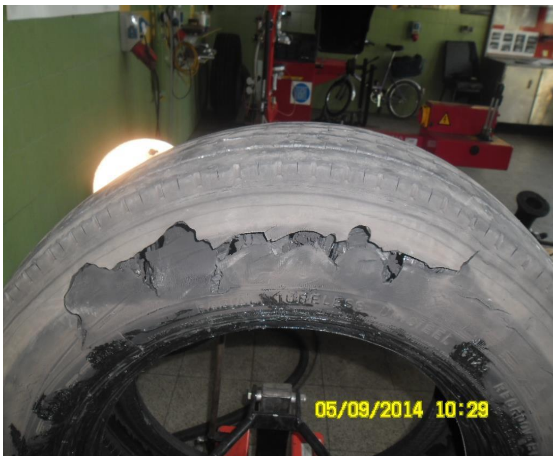
Ryc. 26. Uszkodzenie opony w autobusie Jelcz 081 MB
